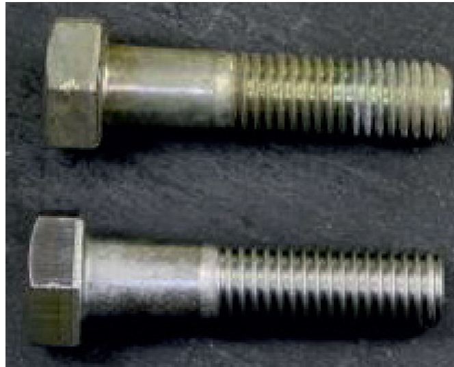
Verzinkte & entzinkte Schraube
