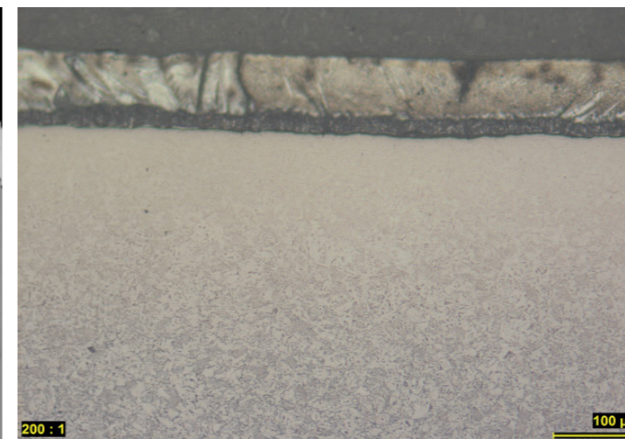
Randgefüge mit Artefakt (vorgetäuschte Randentkohlung)
