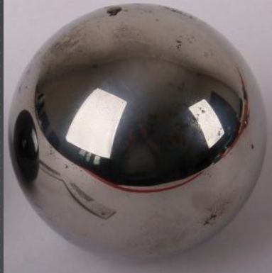
Kugel aus Werkstoff 100Cr6 Ø 60 mm
